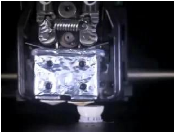
Das Video zeigt komprimiert auf vier Minuten das ca. 30-minütige Drucken einer Kugel im FDM-Verfahren
