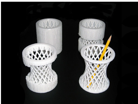
Entfernen von Stützmaterial bei einem 3D-gedruckten Bleistiftständer
