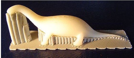
Kunststoffmodell eines Dinosauriers mit schichtweisem Auftrag und Stützstruktur
